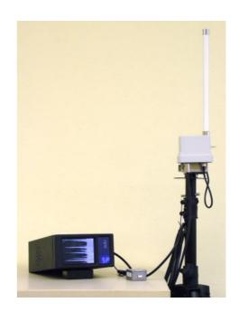
Der Empfänger hat eine integrierte wiederaufladbare Batterie, die einen mobilen Einsatz des Empfängers ermöglicht. Als Standard wird der Empfänger mit eine Rundstrahlantenne mit 6 dBi Antennengewinn, 5 m Anschlusskabel und einem auf 2 m Höhe ausziehbaren, stabilen Stativ geliefert.
